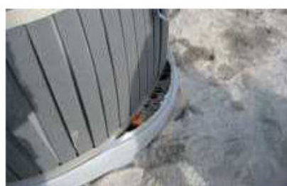
Obrázek 9. Zhroutení kontejneru na směsný odpad přibližně patnáct minut po otevření víka.
