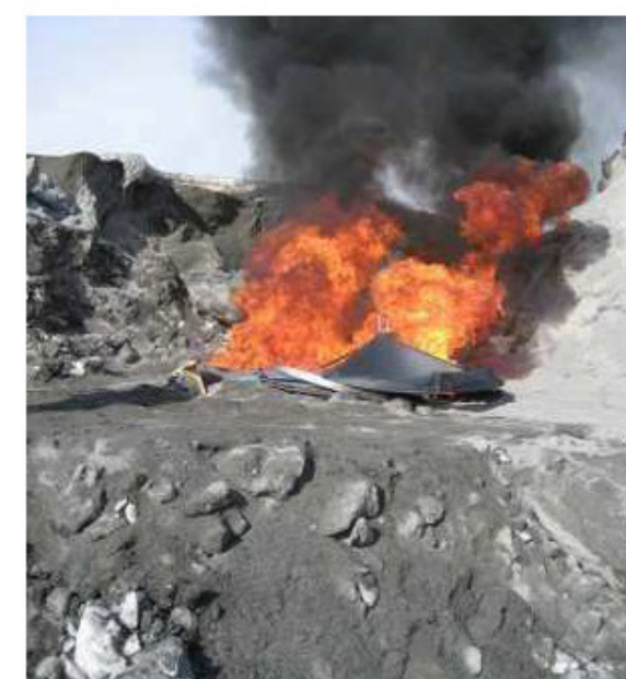
Obrázek 6. Imploze kontejneru přibližně hodinu a pět minut po zapálení: a) naklonění a b) zhroucení.
