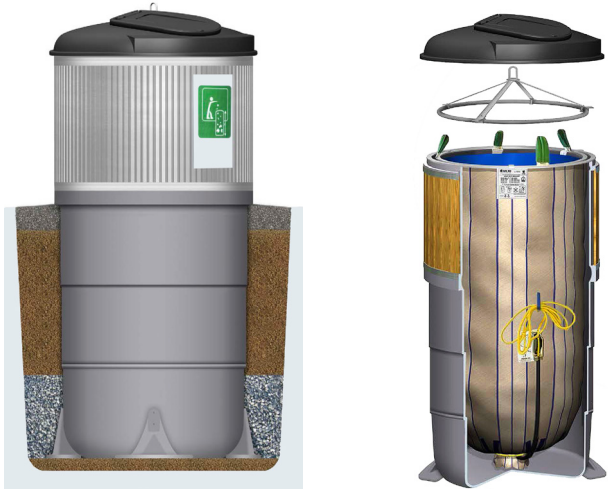
Schema osazení kontejneru Molok Classic (shodné s osazením kontejneru MOLOK DOMINO GLOBAL®, který je odlišný v řešní nadzemní části) a konstrukční schema kontejneru.
